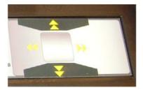
На панели имеется единственная кнопка управления на 5 положений. Таким образом, пользователю не нужно запоминать функции множества кнопок, что делает работу более удобной.
