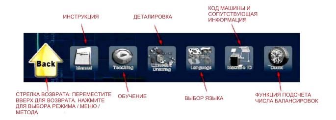
Функция помощи: сюда относится инструкция по эксплуатации, деталировка и обучающий CD-диск, которые дают пользователю более правильную и точную информацию в процессе обучения и эксплуатации.
